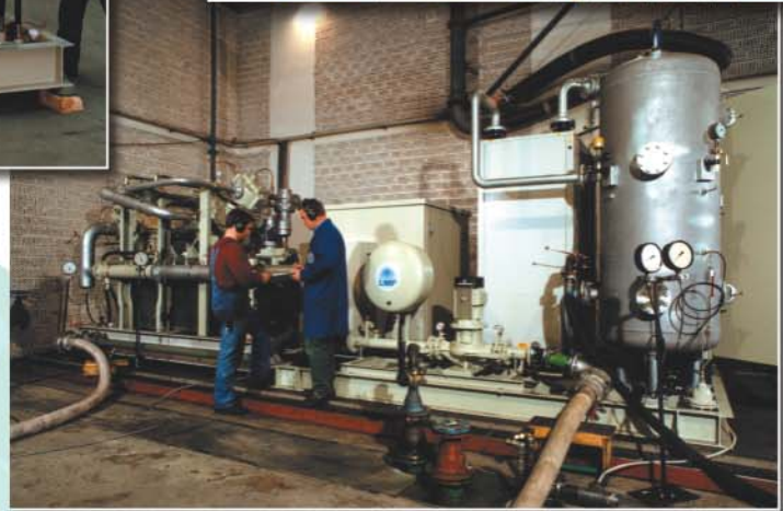
▲ LMF-Prüfstand für EcoPET-Kompressoranlagen
