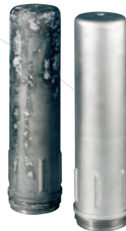
Unbehandelter und chromatierter Aluminiumguss nach einem Salzspraytest gemäß DIN 50021 SS > 250h
