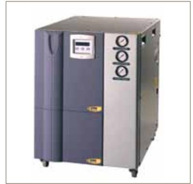
Die Stickstoffgeneratoren des Typs LCMS von Parker domnick hunter setzen robuste, praxiserprobte Technologie ein, mit denen sie den Anforderungen neuester LC/MS-Messgeräte hinsichtlich Trocknung, Umhüllung, Vernebelung und Kollision des Gases entsprechen. Fünf Modelle arbeiten mit Durchflussraten von 15 l/min bis 50 l/min.
