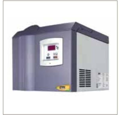
Der Null-Luft-Generator UHP-ZA von Parker domnick hunter erzeugt einen kontinuierlichen Luftstrom, der frei von organischen Verunreinigungen ist, aus einer externen Trockendruckluftquelle und bietet höhere Nachweisgrenzen als andere Versorgungsarten. Die Durchflussraten reichen von 1 l/min bis 30 l/min.
